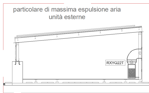
Rappresentazione in sezione della tettoia porta fotovoltaico e delle relative chiusure laterali, oltre all'indicazione del sistema di canalizzazione dei flussi d'aria afferenti all'impiantistica di copertura: le bocche di espulsione saranno tutte orientate in direzione opposta all'edificio residenziale più prossimo (frontisti via Piano Caricatore)
